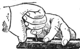
Рис. 77. Отделение выбрасывателя от затвора
