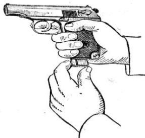
Рис. 69. Вставление магазина в основание рукоятки
