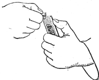
Рис. 115. Снаряжение магазина патронами
