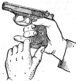
Рис. 64. Извлечение магазина из основания рукоятки
