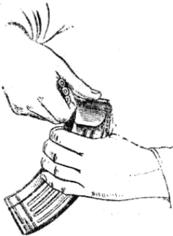
Рис. 101. Снаряжение магазина патронами
